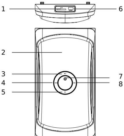
(линейный вход, радио, USB порт или слот для SD карт) осуществляется циклически нажатием на кнопку (5). При использовании источника сигнала, отличного от линейного входа, кнопка (3) позволяет приостанавливать и возобновлять воспроизведение, кнопки (4) и (8) переходить к предыдущей и последующей композиции (радиостанции).
