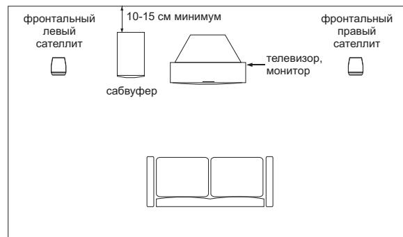
Подключите сателлиты к сабвуферу, к разъемам AUDIO OUTPUT L и R, используя кабели с разъемами RCA, идущие от задней панели каждого сателлита (левый сателлит к гнезду L, правый сателлит - к гнезду R).
