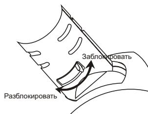
Поверните рычаг на правой стороне рулевой колонки по часовой стрелке, установите необходимую высоту рулевой колонки, верните рычаг в исходное положение.
