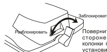
Поверните рычаг на тыльной стороне основания рулевой колонки против часовой стрелки, установите необходимый угол наклона рулевой колонки, верните рычаг в исходное положение.
