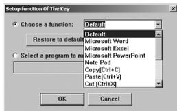
Двойным щелчком на пиктограмме клавиатуры Вы открываете интерфейс настройки клавиш "Key Settings". Щелчком на одной из программируемых клавиш на изображении клавиатуры Вы открываете диалоговое окно "Setup function of the Key". Для программируемой клавиши Вы можете назначить либо запуск приложения или выполнение команды из списка "Choose a function", либо запуск произвольного исполняемого файла "Select a program to run".
