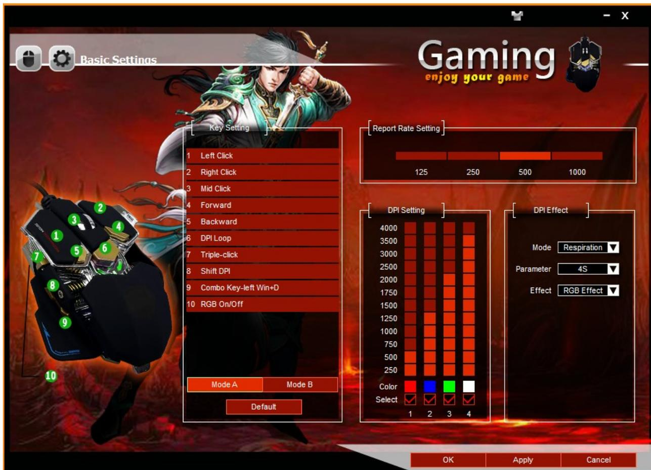
Переключение между окнами с основными настройками Basic Settings и дополнительными настройками Advanced Settings осуществляется нажатием на кнопки с изображением, соответственно, компьютерной мышки и шестерёнки, расположенными в левом верхнем углу окна программы.
